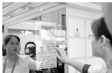
京东方自主研发的智能镜子,采用镜面显示技术,通过在屏幕表面的半透半反结构,增强了光线反射效果,反射率达 60%,且色域高达 72%,将镜子功能及显示功能完美结合。同时,该产品应用了京东方独有的 ADSDS 超硬屏技术,上下左右可达 178 度,多触点的纳米触控功能和 Wi-Fi 功能可轻松实现智能交互、网络浏览等。智能镜子可广泛应用于家庭、酒店、商场、公共场所等领域,其具体性能可根据客户的需求进行相应定制。
