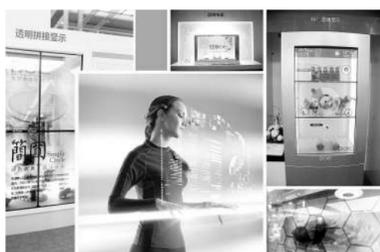
京东方成功开发的全高清透明显示屏,应用了京东方独有的 ADSDS 宽视角技术,具有全高清、宽视角、高色域(72%)和高对比度(1200:1)等优势。透过率达到 9%,无需专用背光源,功耗仅为专用背光源显示屏的十分之一。此外,京东方全高清透明显示屏还可通过遥控开关控制,实现透明显示与正常显示随意切换等功能,具有很强的实用性和互动性。该透明显示屏可融合多点触控、智能显示等技术,作为公共信息显示的终端,用在百货陈列窗、冰箱门透视、汽车前挡风玻璃、自动售货机等各个领域,具有广阔的应用范围,带来视觉新体验。
