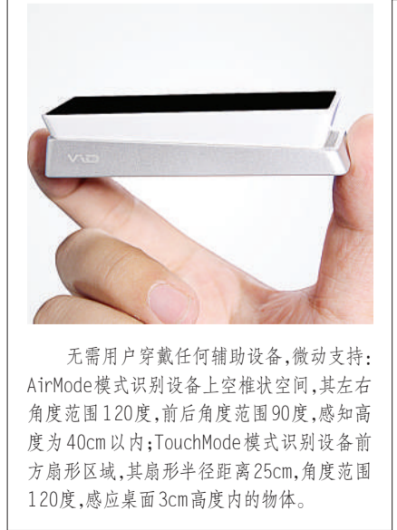
无需用户穿戴任何辅助设备, 微动支持: AirMode模式识别设备上空推状空间, 其在左右角度范围120度, 前后角度范围90度, 感知高度为40cm以内; TouchMode模式识别设备前方扇形区域, 其扇形半径距离25cm, 角度范围120度, 感应面积3cm高度内的物体。
