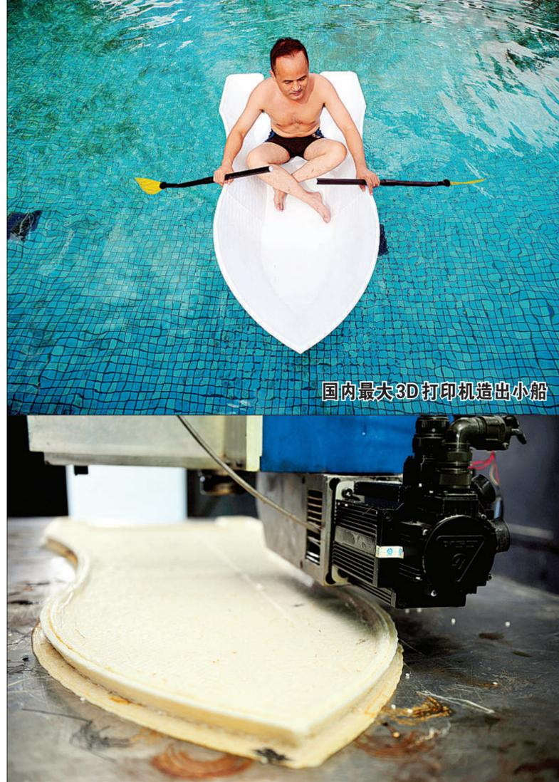
7月13日,三亚思海创新机电工程设计有限公司研制的FDM型3D打印机成功制作出一艘小船,并下水试航成功。小船长2米,宽0.8米,高0.3米,重量35公斤,采用尼龙树脂材料,可搭乘两个成年人。据了解,这台3D打印机可打印6米长、4米宽、2米高的物品,是目前国内最大的3D打印机。
