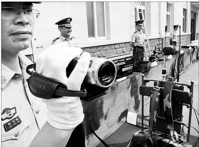
6月23日,工作人员在演示单兵移动可视系统。该系统可实现视频连接指挥中心,实时远程监控和指挥调度。
