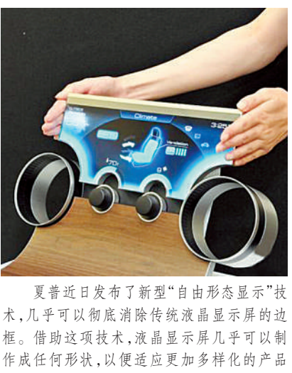
夏普近日发布了新型“自由形态显示”技术,几乎可以彻底消除传统液晶显示屏的边框。借助这项技术,液晶显示屏几乎可以制作成任何形状,以便适应更加多样化的产品外观。
