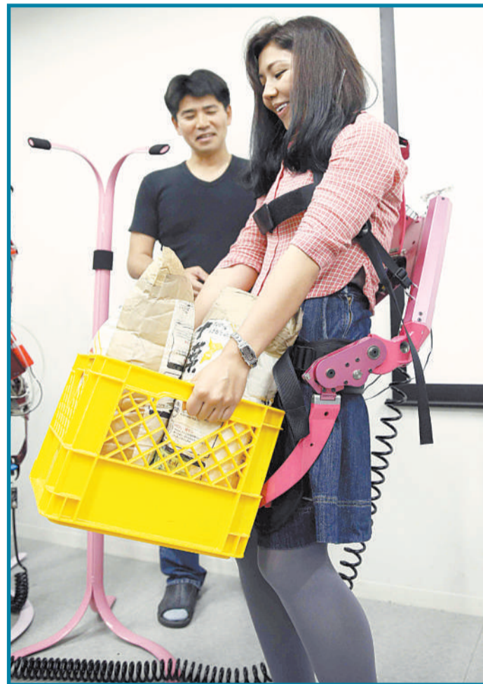
5月13日,日本东京科技大学的工程学院研制一种可以“穿戴”的机器人,主要用于辅助护理和物流操作。它的外表就像一个双肩背包,重量只有4.5公斤,却可以拎起30公斤的重物。
