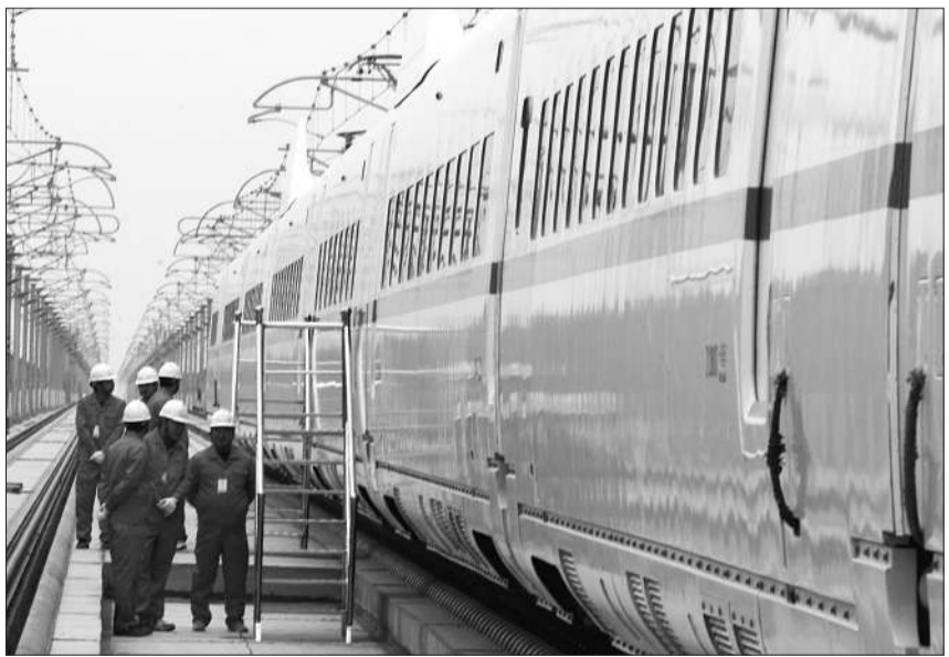
6月3日,兰新铁路第二双线(新疆段)开始联调联试,标志着这一铁路通车运营进入倒计时。兰新铁路第二双线(新疆段)长710公里,于2010年3月开工建设。兰新铁路第二双线横跨甘肃、青海、新疆三省区,全长1776公里,设计最高时速250公里,全线共设31个车站,是目前世界上一次性建设里程最长的高速铁路,预计2014年12月31日全线通车。图为工程技术人员正在对临时停靠在建达坂城湿地大桥的和谐号动车进行联调联试工作。 新华社记者 赵戈摄
