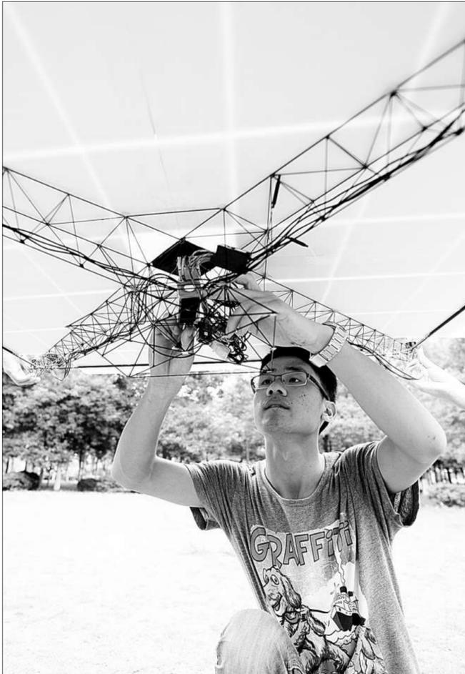
5月29日,由南昌航空大学4名大学生耗时5个月自主制作的太阳能无人飞机成功进行了户外试飞。该飞行器依靠太阳能作为动力,具有垂直起降、空中悬停的功能。机架主体为三棱锥悬挑桁架结构,采用超轻型碳纤维锥杆复合材料制作,全机除电机外没有一块金属,机架主体重69.7克,全机总重1.2千克。图为研发团队全体成员在调试太阳能无人飞机。
