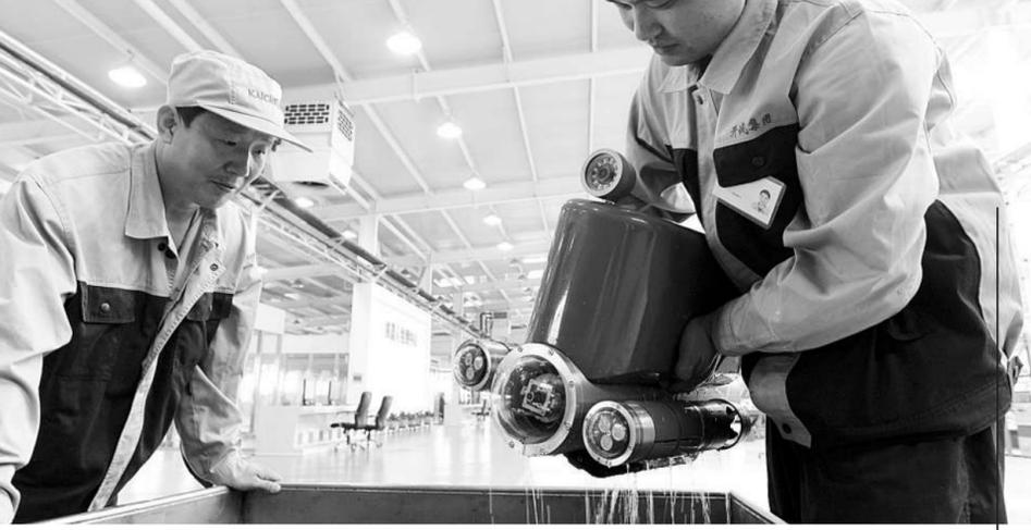
日前,河北首台矿用潜水机器人在河北唐山开诚集团研制成功。图为5月14日,在河北唐山开诚集团机器人生产中心矿用水下机器人总装平台,技术人员对矿用潜水机器人进行水箱静态定深测试。
