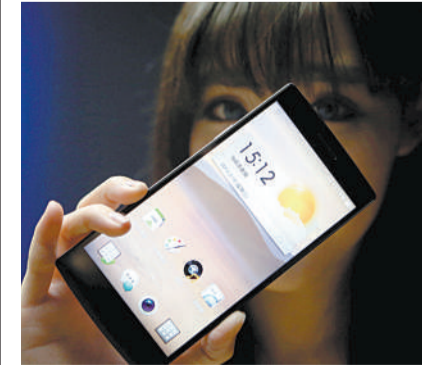
3月19日,OPPO在北京798发布Find 7 4G手机。此款机型配备OPPO研发的4.5V低压快充技术——“VOOC快充”,充电10分钟可以达到电量的25%,充电30分钟可以达到电量的70%。快充技术具备接口过载、电池过
