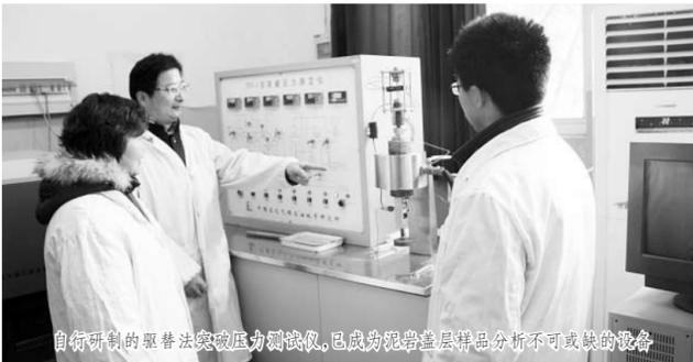
自行研制的驱替法突破压力测定仪,已成为泥岩盖层样品分析不可或缺的设备
