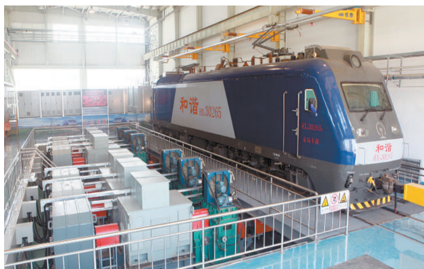
园区企业北京铁道所机车整车动态检测重大装备
