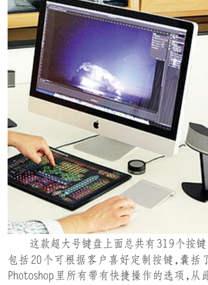
这款超大号键盘上面总共有319个按键,包括20个可根据客户喜好定制按键,囊括了Photoshop里所有带有快捷操作的选项,从此以后只需一键便可完成复杂的动作啦。
