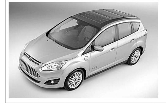
在今年的北美消费电子产品展览上,福特汽车展出了一款太阳能电动汽车。该车政款自福特已有的混合动力产品 C-MAX,不同之处在于车辆顶蓬加装了面积为1.5平方米的光伏电池片。借助这块特殊"玻璃",车辆可以利用太阳能为动力电池进行充电。
