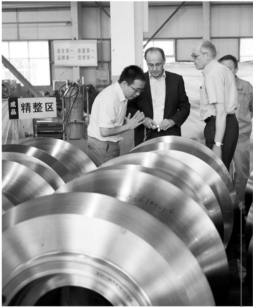
近日，由山东省四方技术开发有限公司生产的一ERW焊管轧辊，经德国西马克专家严格检验，完全达到要求，获得西马克签发的“绿色通行证”，即将起运发往德国。这也标志着中国首创“以铸代锻”焊管轧辊配套设备正式走出国门。
