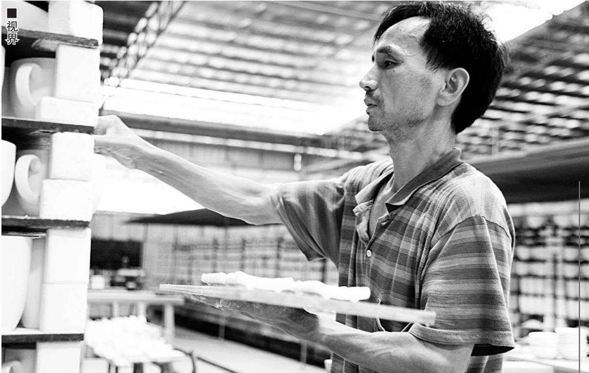
广东宝丰陶瓷科技发展股份有限公司由大埔籍深圳企业家郭福源先生与香港宝丰贸易有限公司合资兴建的外商投资企业，现拥有两条先进隧道窑生产线，主要生产中高端日用陶瓷。图为宝丰陶瓷公司的技术人员在坯器进入烧制生产线之前做质量抽查。
