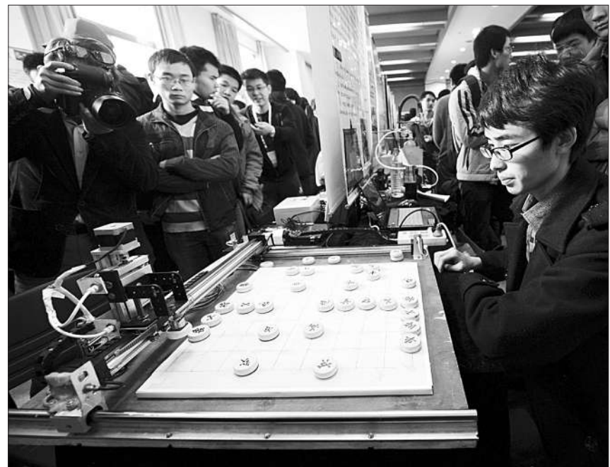
11月23日,江苏省大学生物理及实验科技作品创新竞赛在南京东南大学举行,省内42所高校的学生选手携234项作品参加决赛并进行展示。图为来自常州大学电子科技专业的段旭在与其研制的“智能型实物棋盘人机对弈机器人”下棋,该机器人可感知棋局信息变化,并活动其三机械臂自动移子、吃子,而且棋技高超。新华社记者 孙参摄
