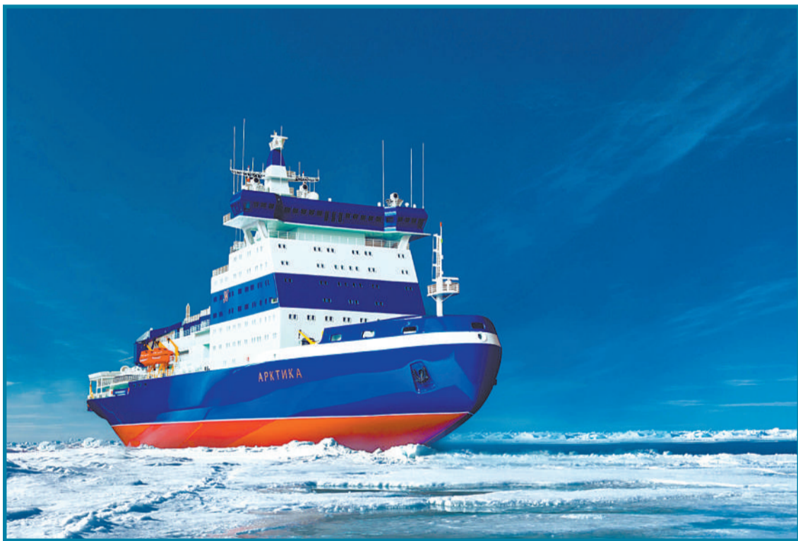
俄罗斯日前开始建造世界上最大的破冰船。该船将于2017年12月进入俄罗斯舰队。船长170米,宽34米,吃水深度10.5米。其反应堆装置的功率将达到175兆瓦,可破除3米厚的冰层。
