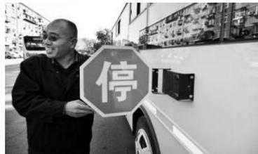
10月24日,工作人員展示校車車身側面裝配的提醒後車減速慢行的臨時停車標識。當日,由天津公共交通集團首次批量定制的14部中小學生專用校車抵達天津。這種校車長8米,除駕駛員和隨車照管員外,可搭載39名學生。前置發動機、車載視頻監控系統、“安芯”智能管理系統、車尾尾部巡視按鈕等使這種校車的安全性大大提升。據介紹,天津公共交通集團將採取類似班車的學校專線模式運營,中途設站接送學生上下學。
