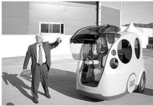
美国公司计划推出零排放零污染的汽车。这款环保车型的车体由玻璃纤维和泡沫塑料组成,采用一台内嵌式电脑显示速度和引擎转速。
