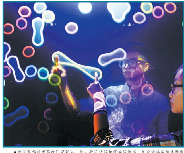
▲韩国科学技术高级研究院展出的一款多功能触摸屏显示墙。民众能够在墙体两侧看到对方。该墙在有机玻璃中间植入一款全息式荧幕,表面转换器能够让使用者听到彼此的声音,感受到震动。
