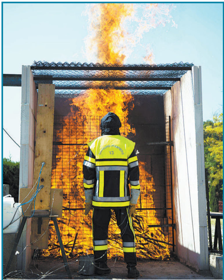
▼9月3日,法国加尔达纳,消防员身着新款材料防护服进行防火、耐火试验。
