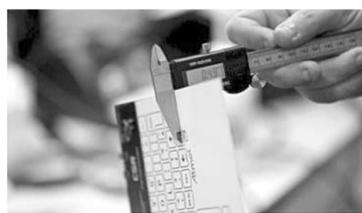
英国蓝牙设备制造商CSR的科学家发明了世界上最薄的柔软可弯曲键盘,厚度仅0.5毫米。这款薄如纸的键盘能够将任何区域变成一个触摸感应表面。
