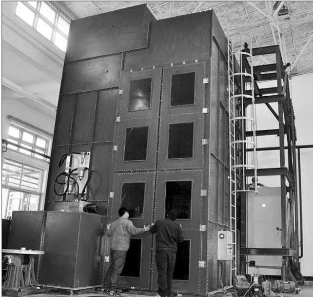
由北京市科委支持北京航空航天大学研制的大型金属构件激光成形增材制造成套装备，该成果主要用于航空航天复杂构件整体加工。
