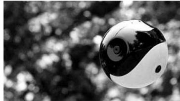
美国发明家史蒂文·霍林格设计了一款可抛掷球形照相机,其尺寸与一个网球差不多,内置3台全景照相机、一个方位传感器、一个微控制器、一个图像处理器以及一个图像稳定器。它可以由一个人抛给另一个人并在飞行过程中拍摄多幅照片,而后将照片拼接在一起,形成一幅全景航拍照。
