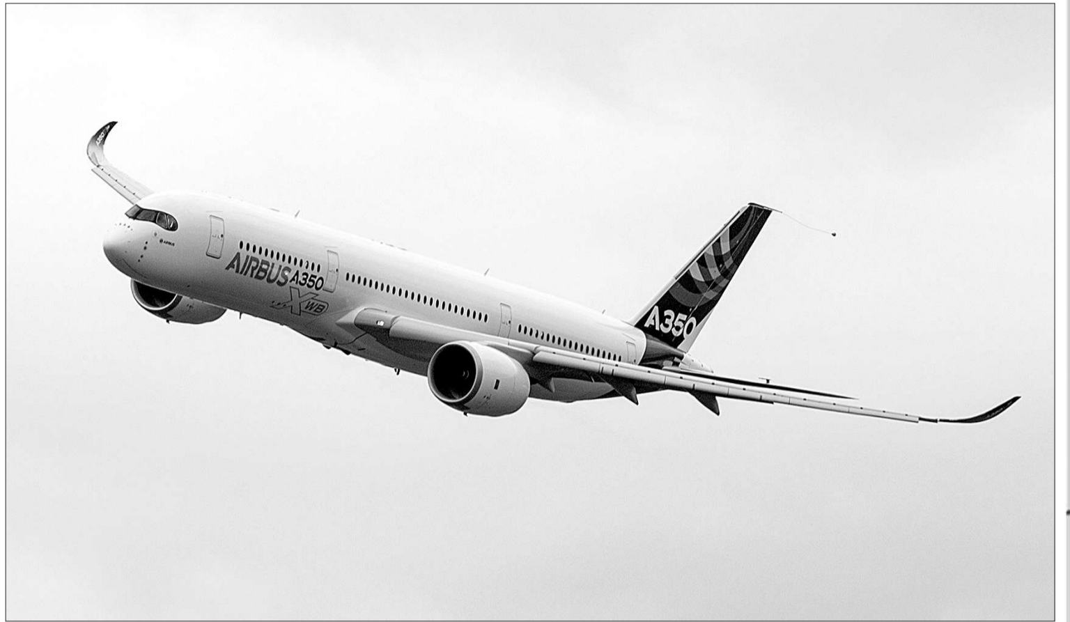
▲空中客车(空客)公司研制的全新宽体飞机A350XWB在巴黎布尔歇机场上空低空飞行。A350XWB宽体飞机机体结构53%由复合材料制造，重量更轻，每座燃油效率比目前的同级别飞机提高25%，排放减少25%。我国企业也参与这款飞机部件设计与制造。A350XWB宽体飞机成为本届巴黎航展明星，帮助空客收获两笔大额订单。 新华社发
