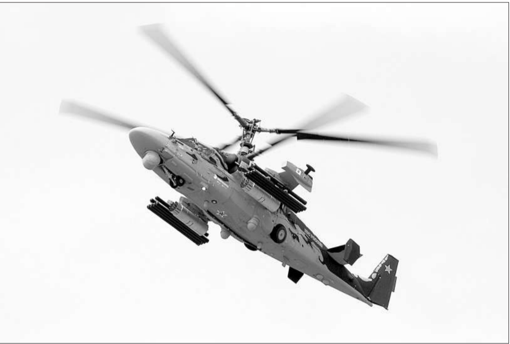
▲俄罗斯卡-52武装直升机在法国巴黎航展上作飞行表演。卡-52是俄罗斯卡莫夫公司研制的共轴反转昼夜全天候战斗直升机。与美国阿帕奇、欧洲虎式直升机不同，卡-52采用俄海军舰载直升机的经典设计：同轴反转双旋翼，无尾桨。这是卡-52首次以实机参加巴黎航展，并携外挂进行飞行表演。 新华社发
