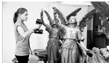
加拿大Creafom公司最近推出了一款名为“Go! SCAN 3D”的三维扫描设备。该扫描设备大小与无绳电钻相当,重量仅为1.1千克,能用单手轻松握住。它安装有环绕着白色LED灯的摄像头,任何人无需经验都可以对物体表面进行扫描。该扫描仪能根据物体的几何形状进行扫描,有定位目标点均可扫描。扫描获得的图像可以通过Creafom的软件进行分析,生成精度达0.1毫米的三维几何图像。
