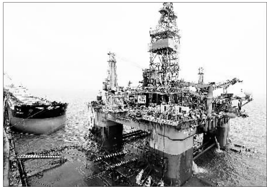
中国研制的首座超深水钻井平台在上海交付。图为“海洋石油981”3000米超深水半潜式钻井平台。
