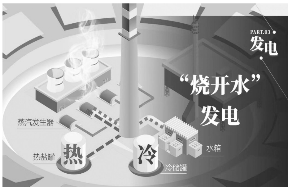
需要发电时，把热盐罐的高温熔盐和水箱中的水打入蒸汽发生器，实现“烧开水”发电。 制图/董旭瑞
