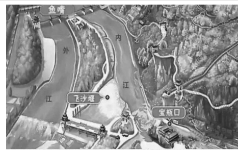
都江堰水利主体工程（鱼嘴、飞沙堰、宝瓶口）示意图
