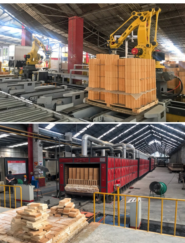
上图百年老厂内，国产智能机器人正在分拣、码垛。下图为国内先进的高温节能隧道窑正在出砖作业。程萍 摄
