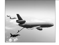
空中加油指在飞行中由一架飞机 ——加油机,给另一架或多架飞机 ——受油机,加注燃油的过程。
