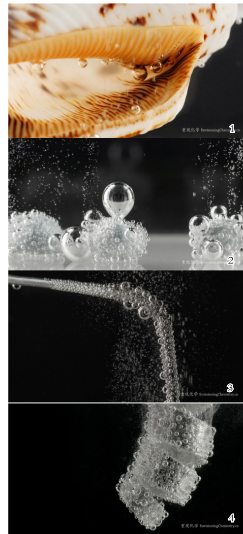
图1: 碳酸钙与盐酸反应生成气体。 图2: 金属锌与盐酸反应生成气体。 图3: 金属铁与盐酸反应生成气体。 图4: 金属铝与氢氧化钠溶液反应生成气体。
