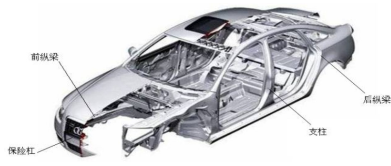
奥迪A8(保险杠、前后纵梁、支柱均为金属泡沫材料制品)
