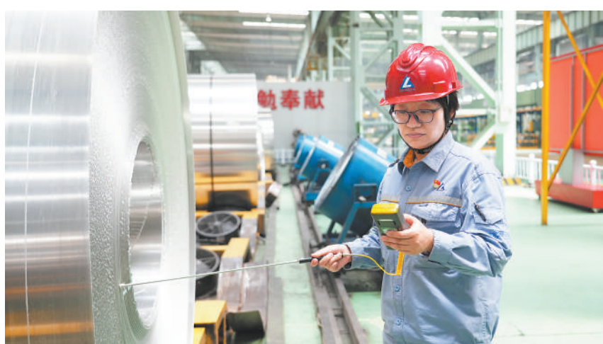
路丽英在检测铝卷的表面温度。
