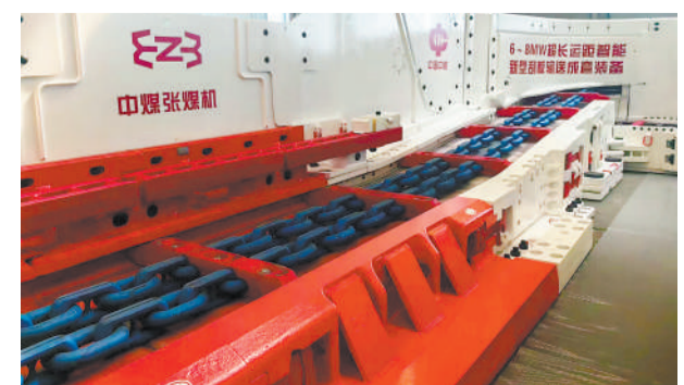
图为世界首台套8兆瓦超长运距智能刮板输送装备。 本报记者 孙明源摄
