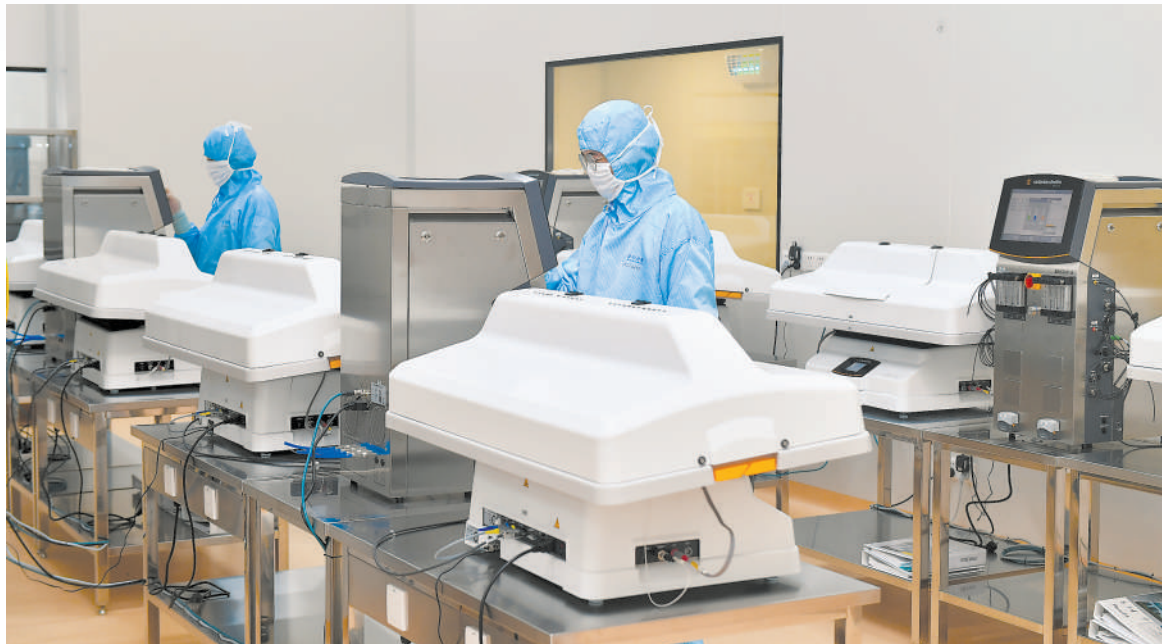
工作人员在使用生物反应器进行细胞培养。(程兆)
