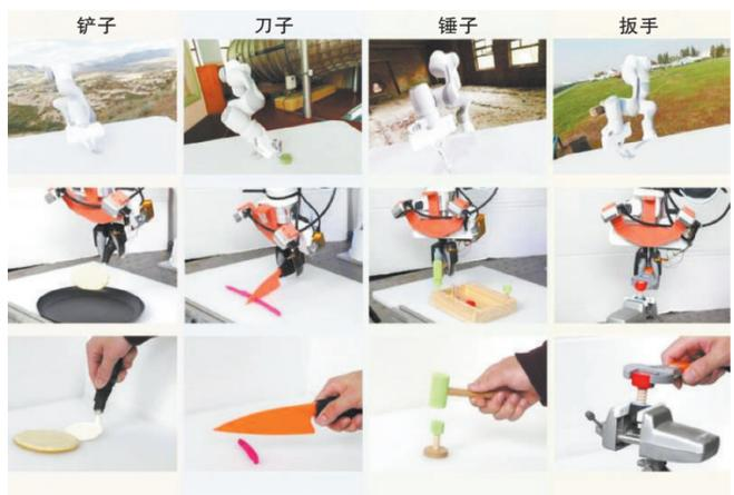
3个不同的数据集:模拟(上)、机器人远程操作(中)和人类演示(下)让机器人能学习使用不同的工具。图片来源:麻省理工学院
