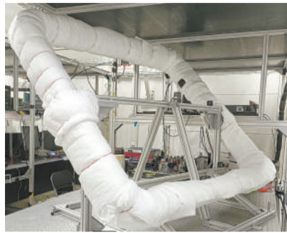
萨格纳克干涉仪2公里长的光纤缠绕在边长1.4米的方形铝制框架上。 图片来源:奥地利维也纳大学
