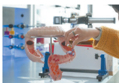
一种可以毫米分辨率定位肠道内智能药丸的可穿戴系统。
