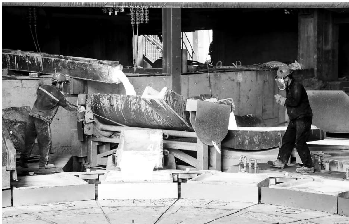
图为包头稀土高新区华鼎铜业全底吹全热态三连炉连续炼铜生产线。受访者供图
