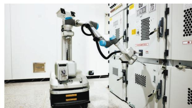
智能操作机器人在110千伏天宁变电站进行倒闸操作。受访者供图
