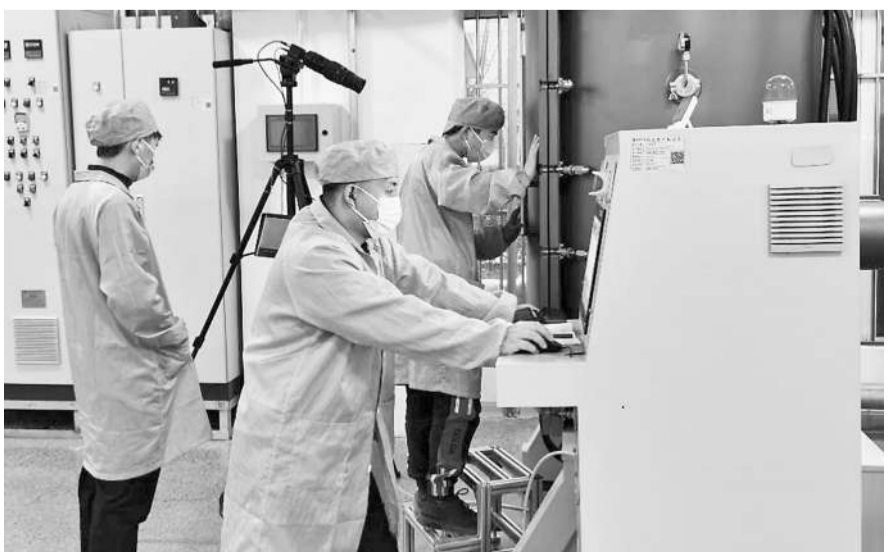
在济南高新区临空经济区内，恒元光电工作人员正在操作晶体提拉炉。受访者供图
