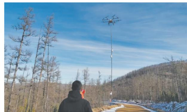
研究人员进行无人机低空磁测设备升空试验。受访单位供图
