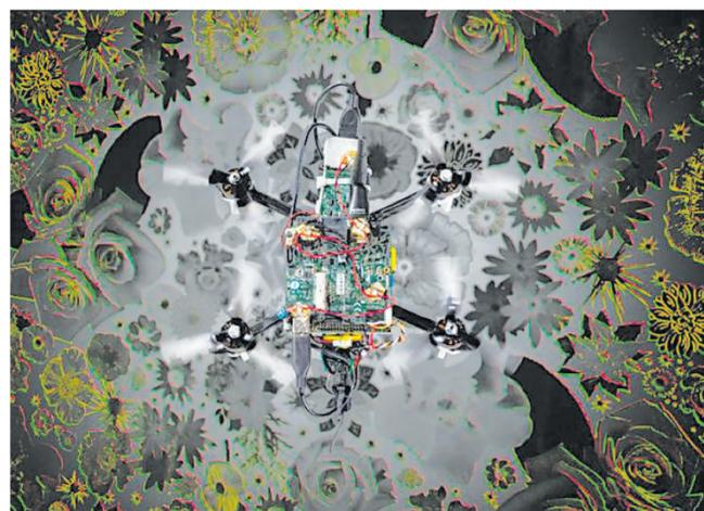
左图为第一代采用完全视觉控制的神经形态AI无人机。右图为神经形态无人机飞越花朵图案,无人机从放在角落的神经形态相机接收到视觉输入。红色表示像素变暗,绿色表示像素变亮。
