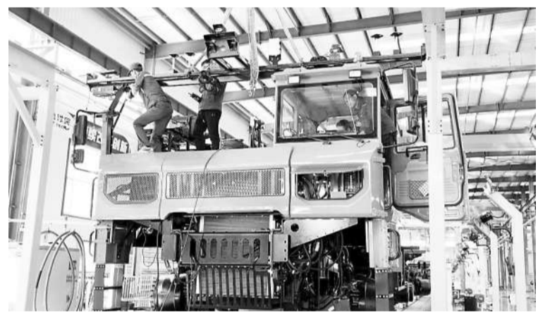
在准格尔经济开发区内蒙古辰辰智能装备有限公司生产车间内，工人们正在加紧装配136吨无人驾驶纯电动宽体矿用矿车。王丽曼摄
