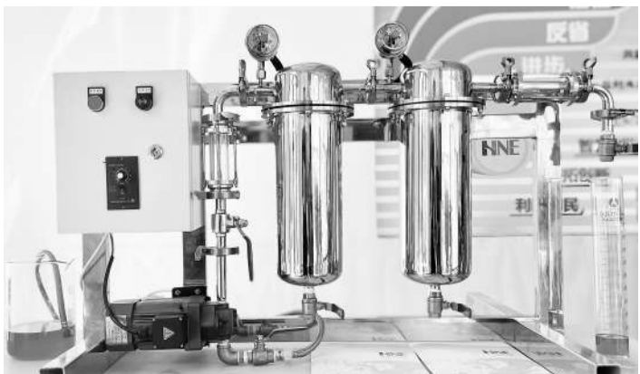
图为青岛海纳能源环保科技有限公司自主研发的工业润滑油在线净化设备。肖玲摄
