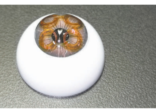
上图 用于接收隐形眼镜数据的无线射频装置。
