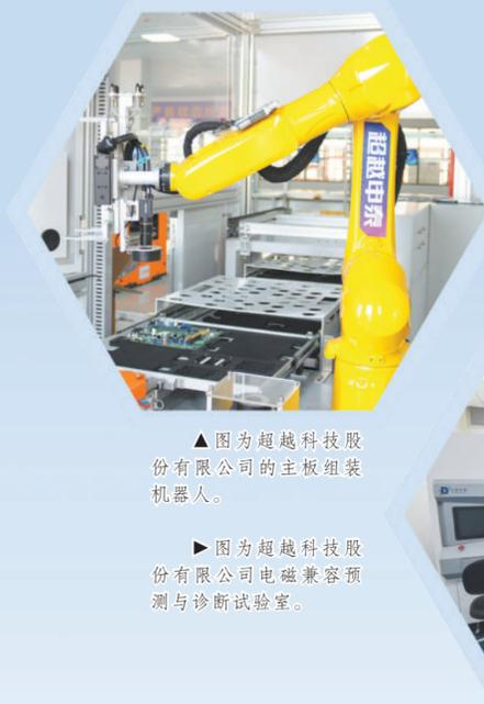
▲图为超越科技股份有限公司的主板组装机器人。
