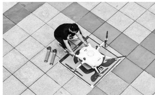
近期,湖南省首条常态化低空物流应用航线在长沙县开通。航线采用可载重4.5公斤、巡航速度每小时60千米的无人机执行配送任务,无人机最大配送范围半径达7千米。今年,当地预计再开通5—10条无人机物流配送航线,实现不低于1万架次的物流无人机飞行量。图为在长沙县一街边公园,安全员给无人机更换电池。
