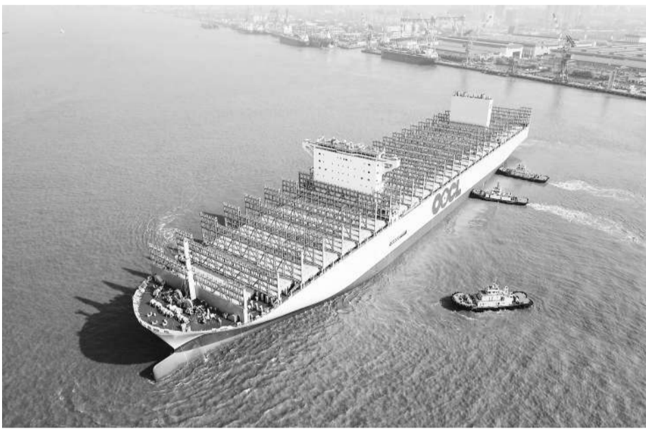
5月7日，由江苏南通中远海运川崎船舶工程有限公司自主设计、研发制造的“中远川崎397”集装箱船出海试航。该船长399.99米、型宽61.3米、型深32.2米，可装载24188个国际标准集装箱。图为“中远川崎397”集装箱船出海试航（无人机照片）。 新华社发（吴树建摄）
